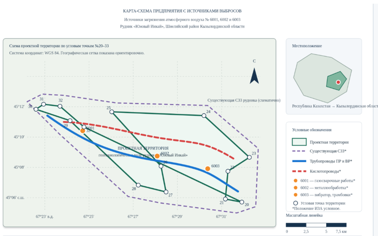
Рис. 8. Карта-схема площадки с нанесенными на нее источниками выбросов загрязняющих веществ в атмосферу и СЗЗ – 500 м
