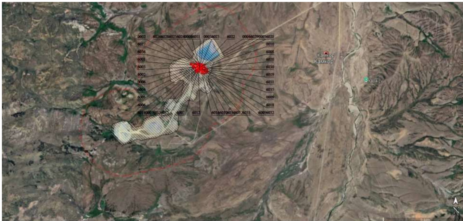
Рисунок 2.1 – Карта-схема района расположения месторождения Камкор с указанием границ санитарно-защитной зоны, источников выбросов
