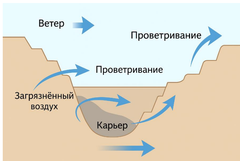
Рисунок 2-6 Схема проветривания карьера
