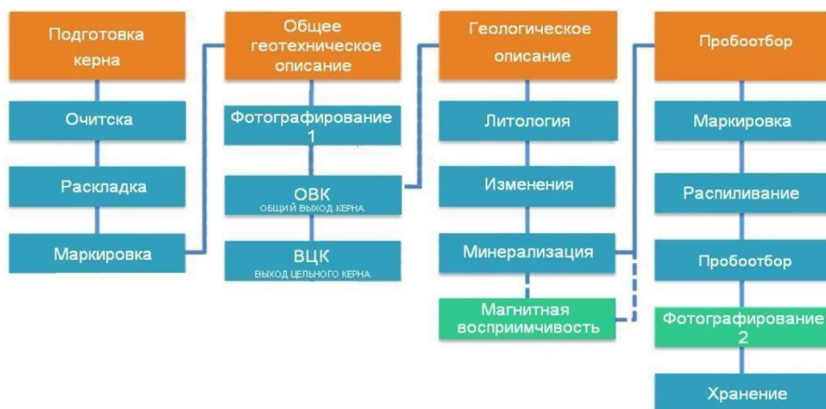
Рис. 2 Технологическая схема документации и обработки керна
