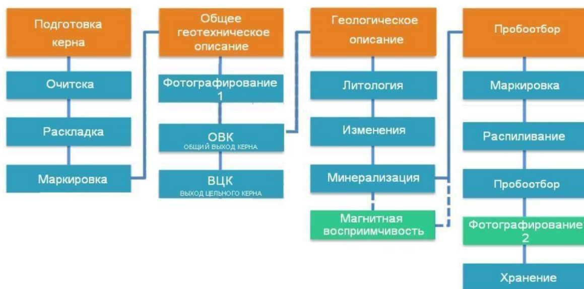
Рис. 2 Технологическая схема документации и обработки керна
