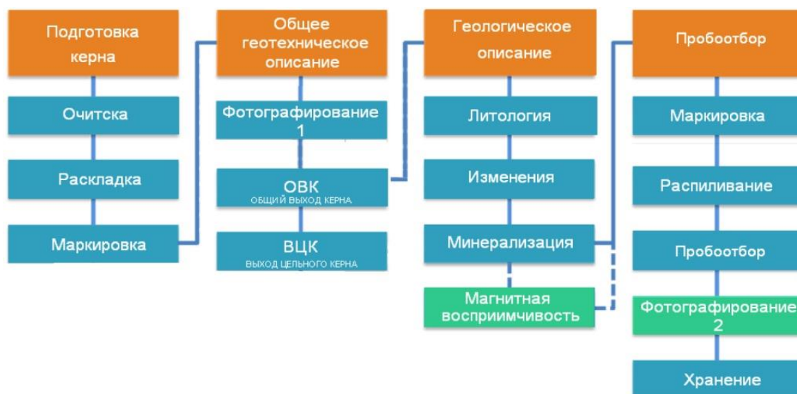
Рис. 2 Технологическая схема документации и обработки керна
