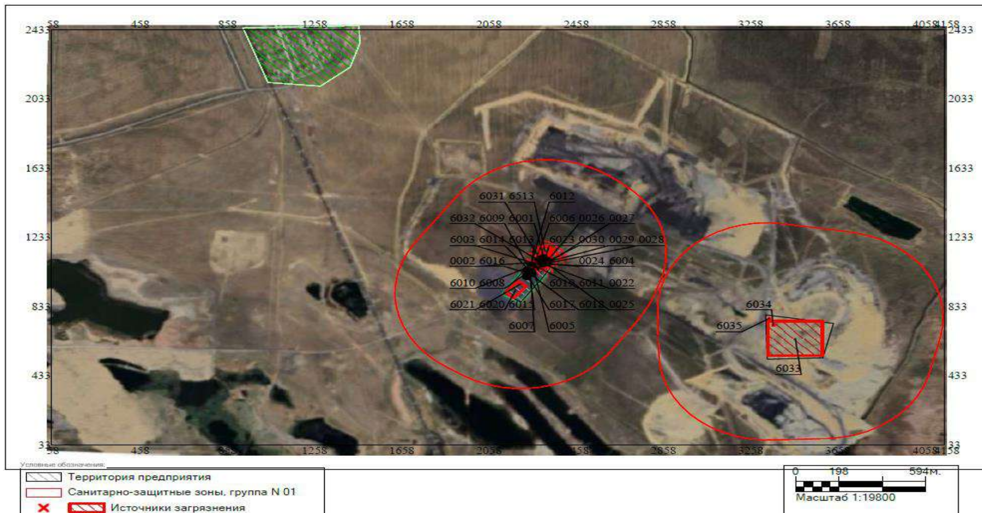
Рисунок 1.4 – Карта-схема объекта с нанесенными на нее источниками выбросов загрязняющих веществ в атмосферу
