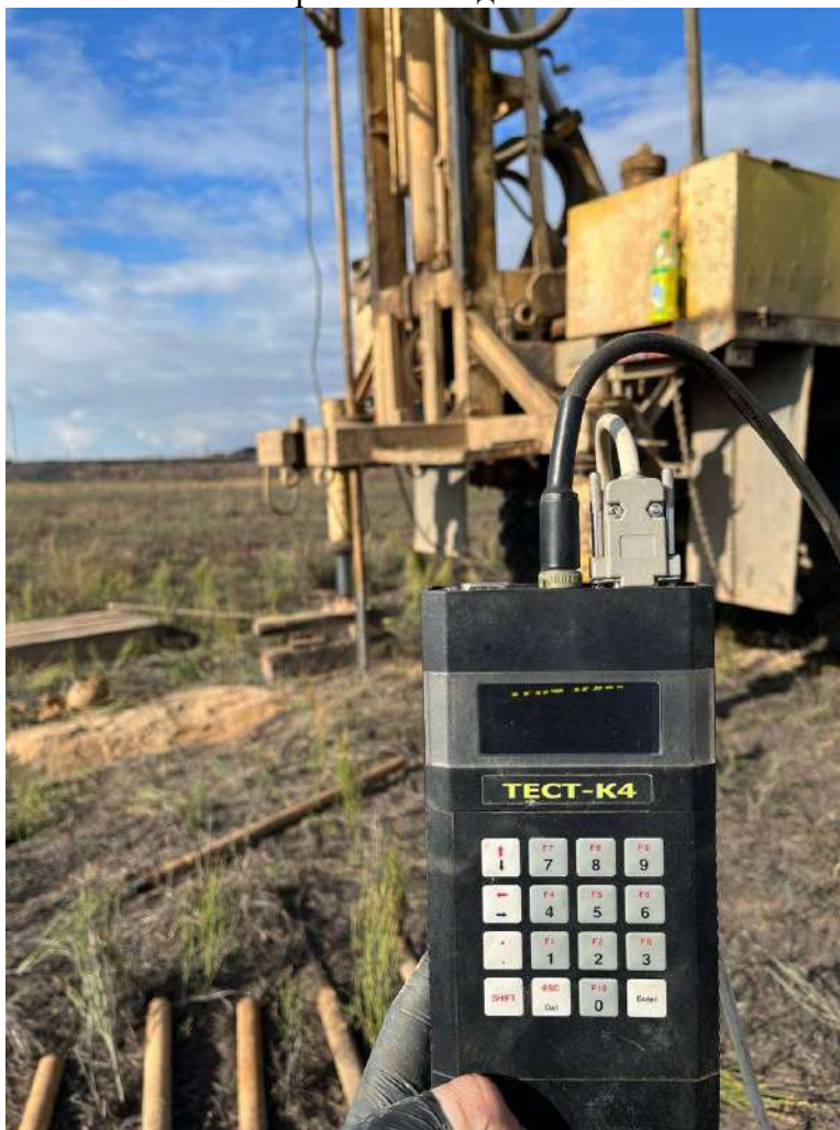
Рисунок 10. Фиксирование данных статического зондирования
