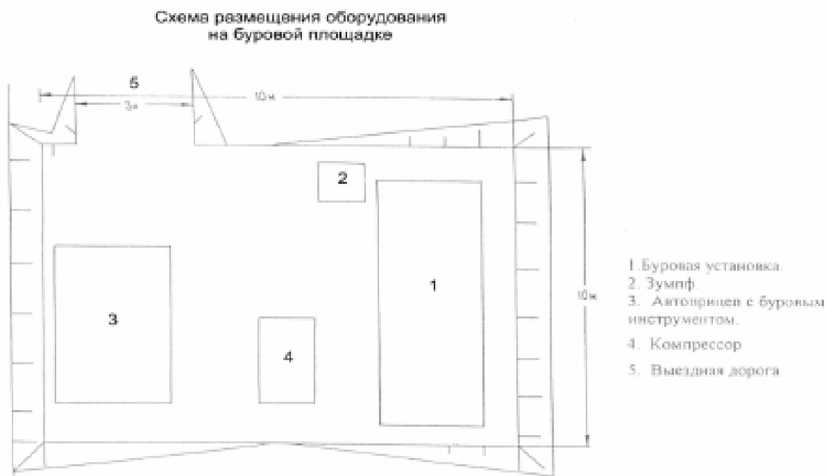
Рисунок 5. Схема размещения оборудования на буровой площадке.
