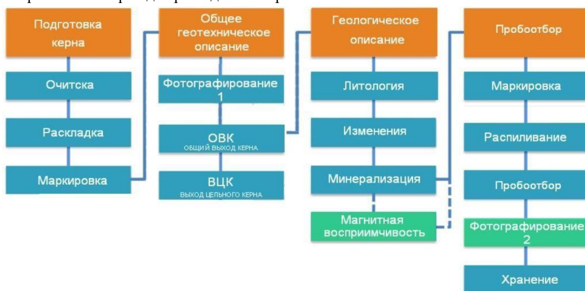
Рис. 5.1 Технологическая схема документации и обработки керна
