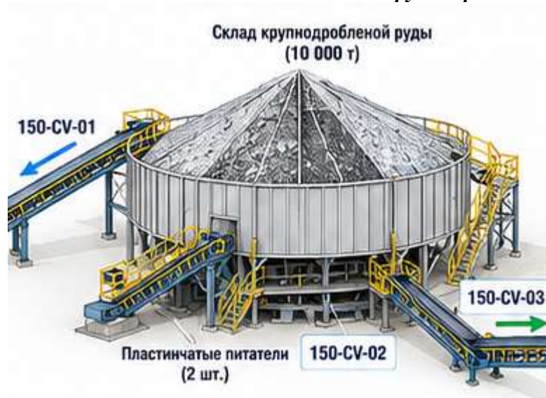
Рисунок 7.3 Технологическая схема склада крупнодробленой руды
