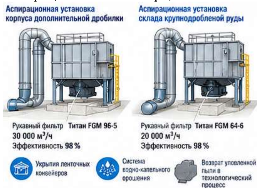
Рисунок 7.7 Принципиальная схема аспирации и пылеподавления ДСК
