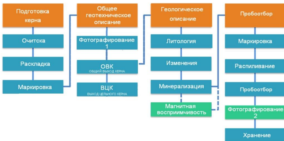
Рис. 2 Технологическая схема документации и обработки керна
