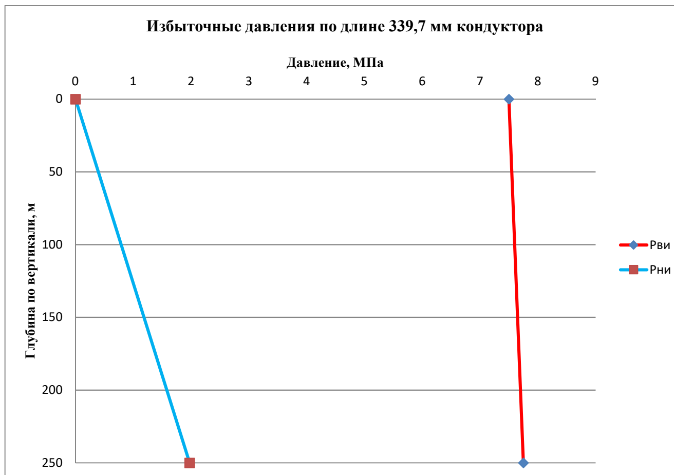
Рисунок 9.1. Эпюра избыточных давлений по длине 339,7 мм кондуктора
