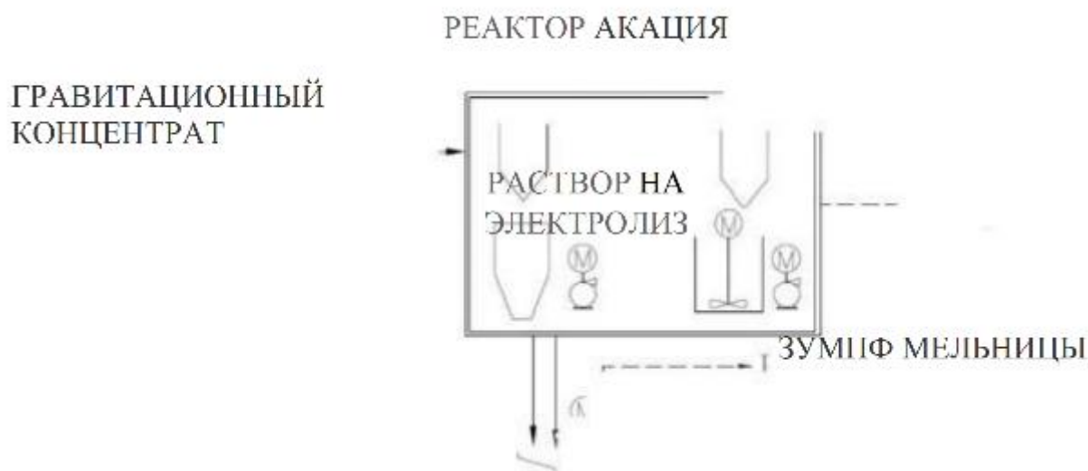
Рисунок 1.11 Схема цепи аппаратов переработки гравитационного концентрата.
