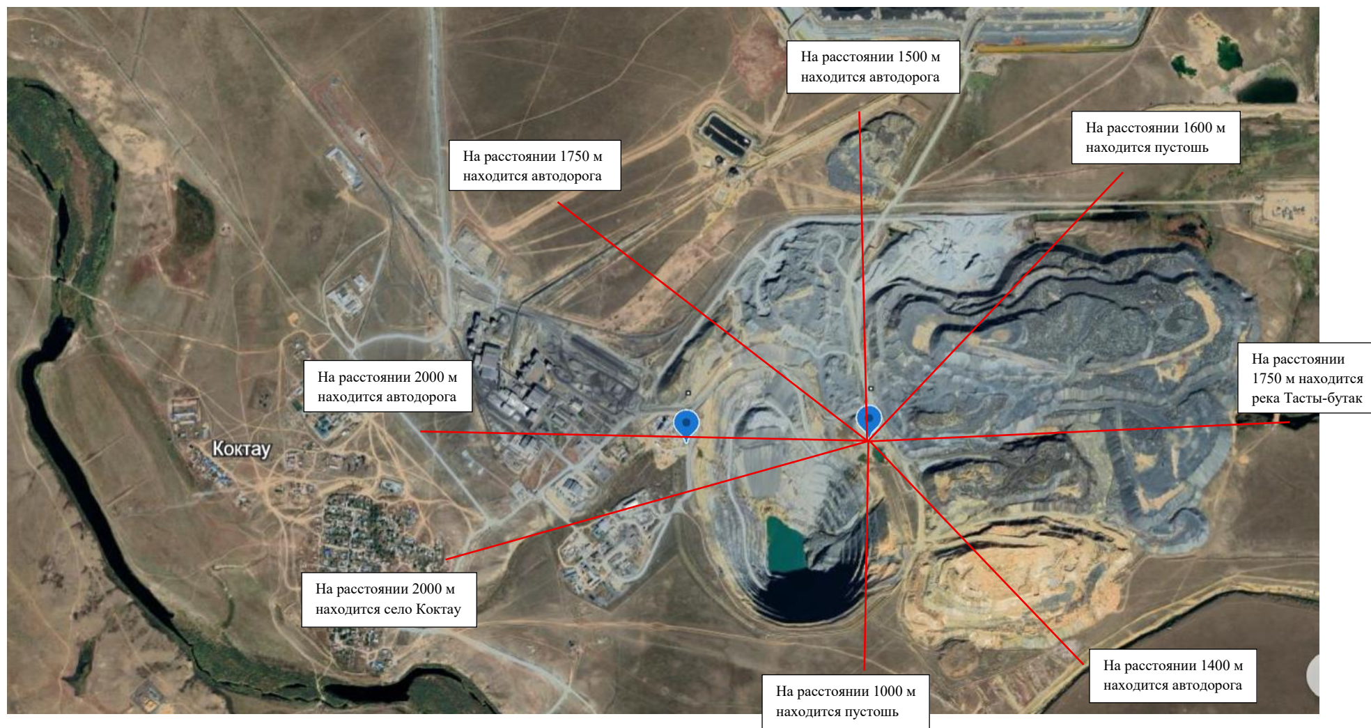
Рисунок 2 - Схема объекта “Бетонозакладочный комплекс №1” с текстовым описанием трассировки границы СЗЗ по 8 (восьми) румбам с указанием расстояний и расчетных точек от источника выбросов загрязняющих веществ
