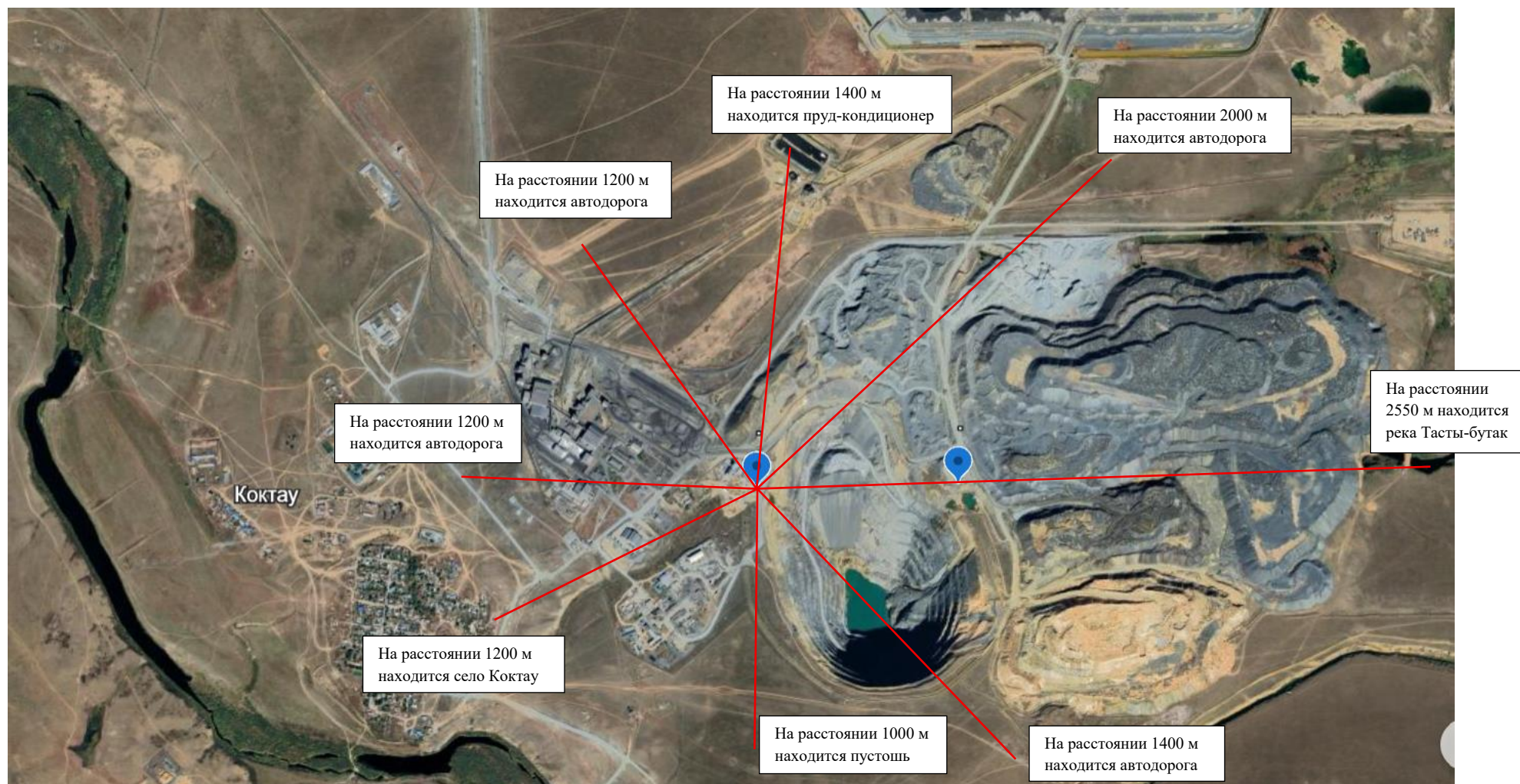
Рисунок 2 - Схема объекта “Комплекс ствола “Клетевой” с текстовым описанием трассировки границы СЗЗ по 8 (восемь) румбам с указанием расстояний и расчетных точек от источника выбросов загрязняющих веществ
