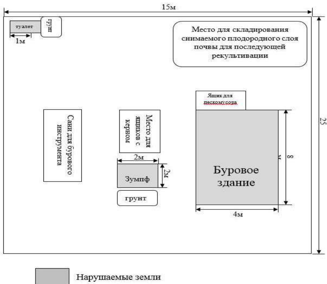
Рис.4.2 - Схема размещения бурового оборудования на площадке
