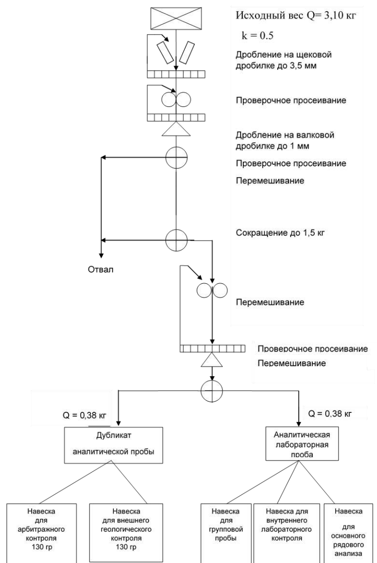
Рис. 4.5 - Схема обработки крновых проб
