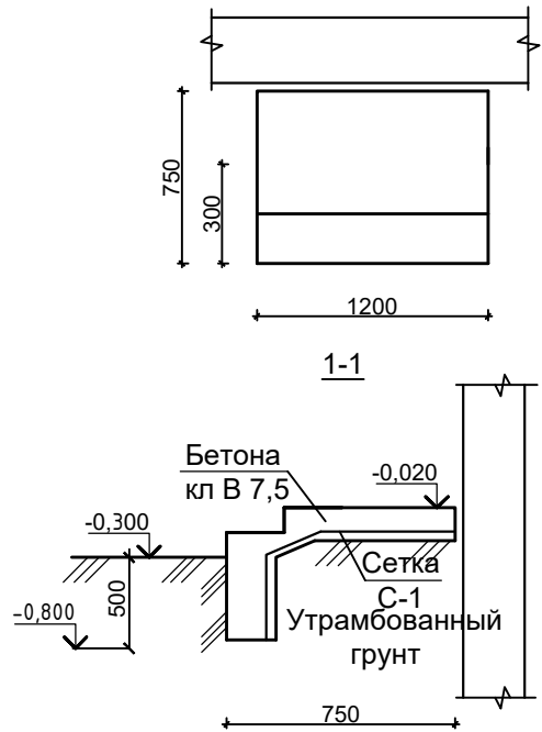
Входное крыльцо Кв-1. Опалубочный чертеж.
