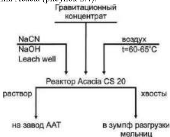
Рисунок 2.4 - Технологическая схема выщелачивания золота из гравитационного
