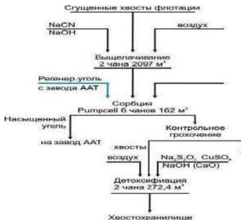
26 Рисунок 2.5 - Технологическая схема выщелачивания золота из гравитационного концентрата
