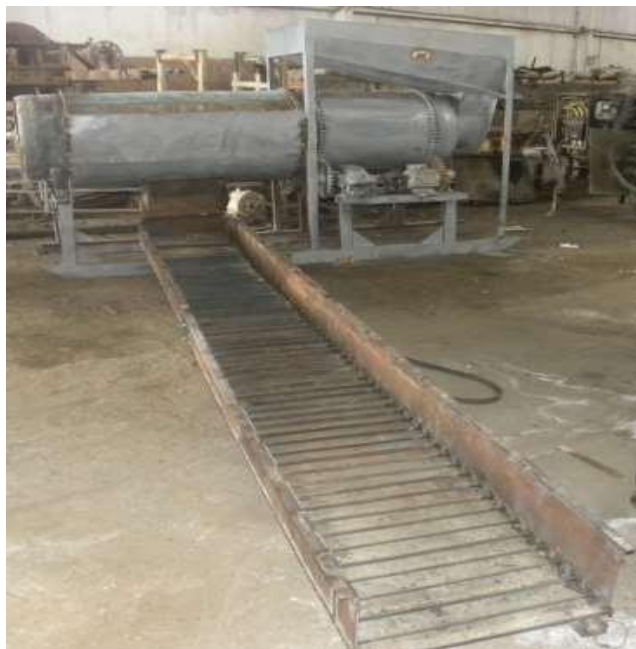
Рисунок 5. Внешний вид промывочной установки со скруббер бутарой
