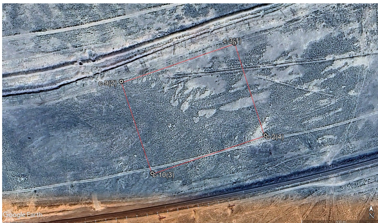
● c-1(1) местоположение и номер разведочной скважины, в скобках - угловые точки участка; - граница (контур) участка; - железная дорога Достык-Моинты Рис 1.10 Схема участка «№24-Р» с расположением скважин (на основе космоснимка)
