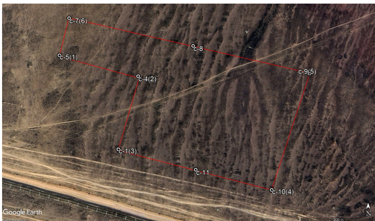
● c-1(1) местоположение и номер разведочной скважины, в скобках - угловые точки участка; - граница (контур) участка; - железная дорога Достык-Моинты Рис 1.6 Схема участка «№4Д» с расположением скважин (на основе космоснимка)
