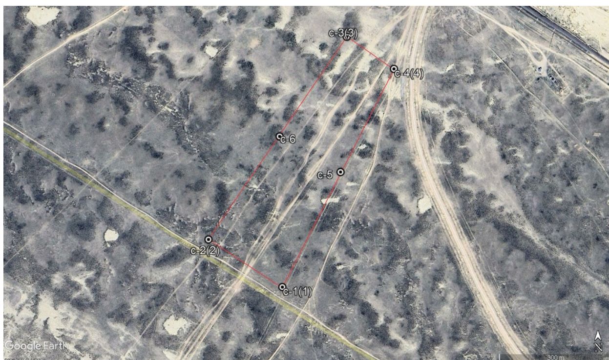
● c-1(1) местоположение и номер разведочной скважины, в скобках - угловые точки участка; - граница (контур) участка; - железная дорога Достык-Моинты Рис 1.5 Схема участка «№9Ж» с расположением скважин (на основе космоснимка)
