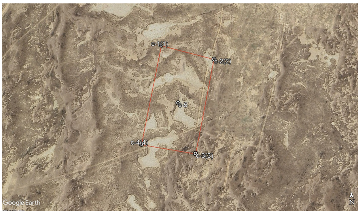
● c-1(1) местоположение и номер разведочной скважины, в скобках - угловые точки участка; - граница (контур) участка; - железная дорога Достык-Моинты Рис 1.8 Схема участка «№27А-Р» с расположением скважин (на основе космоснимка)
