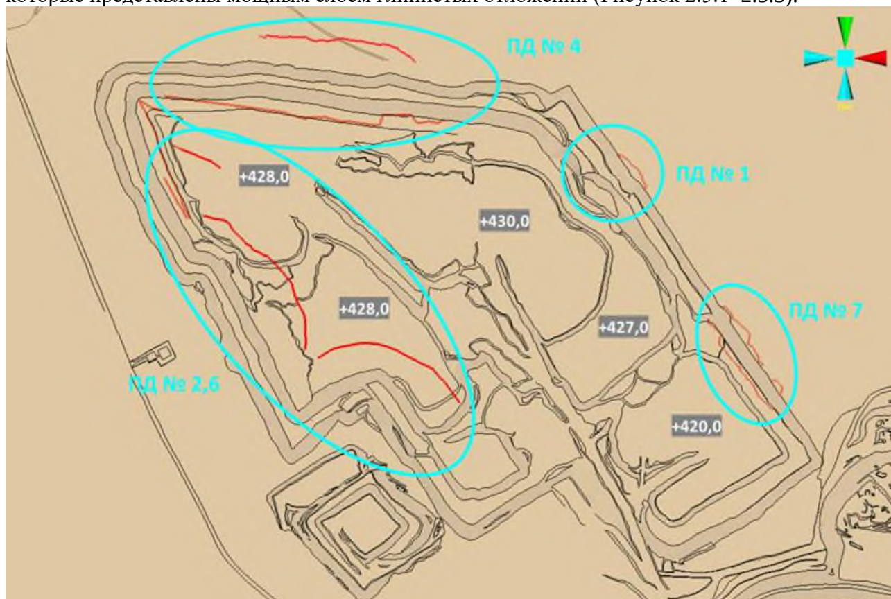
Рисунок 2.3.1 – Ситуационный план ОПП-1 с нанесенными участками распространения участков деформаций отвала вскрышных пород (отмечены красным)
