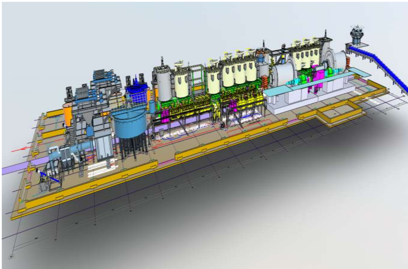
Рисунок 3.6.6.2г – Принципиальная аппаратурная схема переработки дробленой руды с получением коллективного медно-свинцового и цинкового концентрата Отделение сгущения, перечистки и пресс-фильтров.
