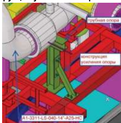
Рисунок 2.2.1-12 Конструкция усиления опоры 2-й технологической линии
