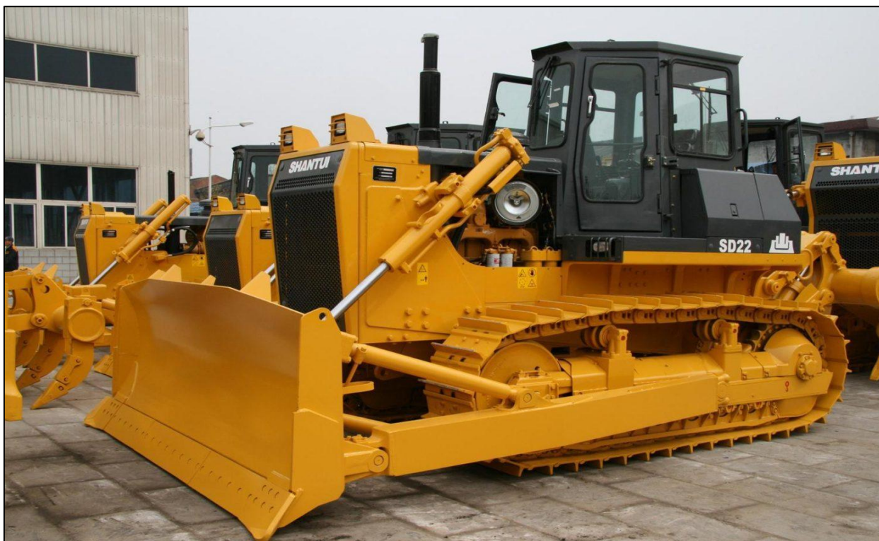
Рис. 5.6 Бульдозер Shantui SD22
