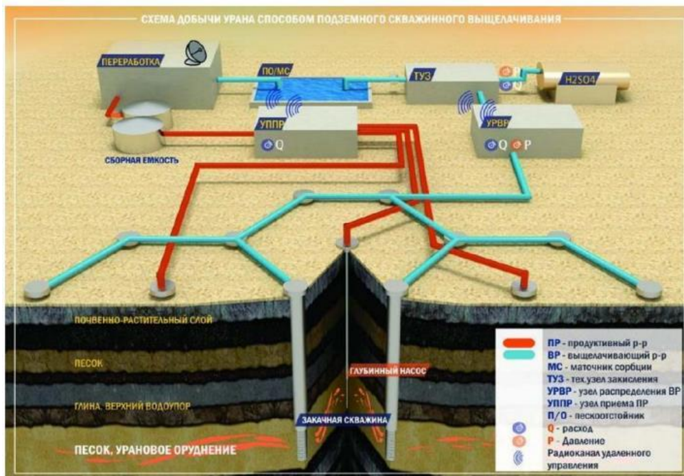
Рисунок 2.1.1 — Схема добычи урана способом ПСВ
