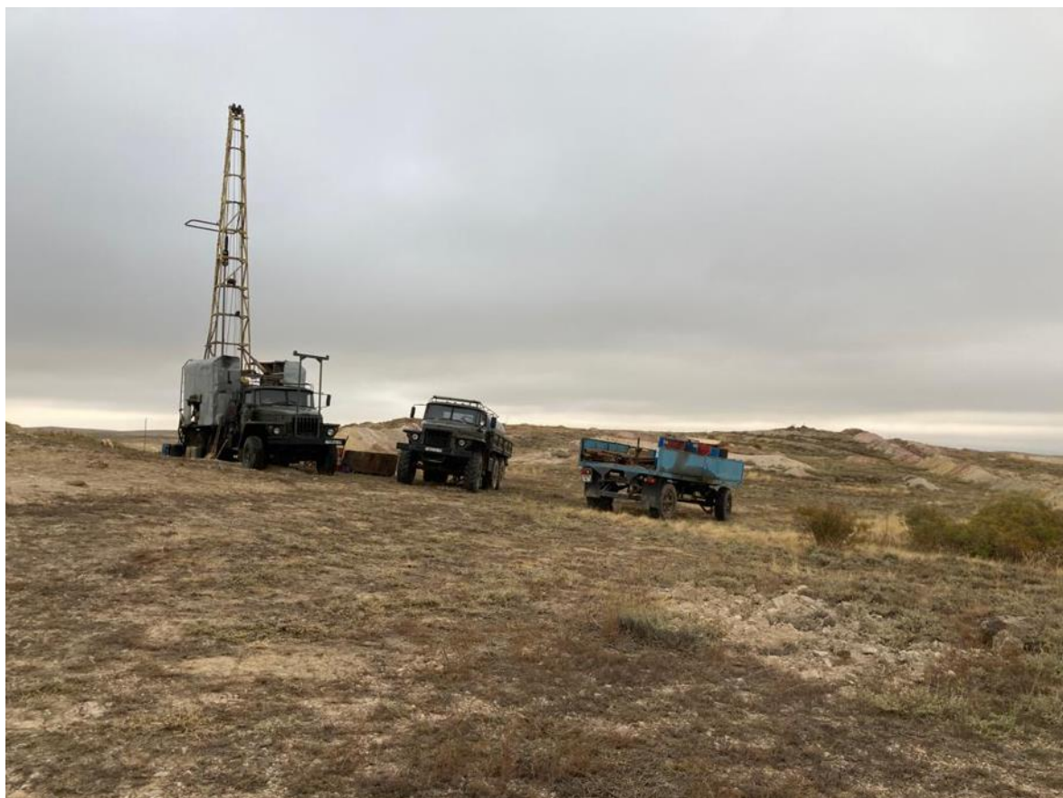
Рисунок 2.4 – Производство колонкового бурения на месторождении «Студенческое»
