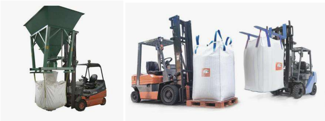
Рисунок 7 - Процесс подачи загрязненного грунта в биг-бэги
