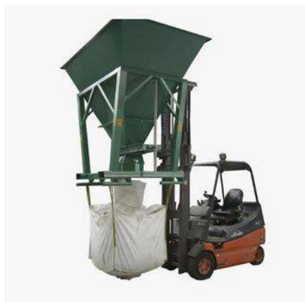
Рисунок 9 - Процесс подачи загрязненного грунта в биг-бэги
