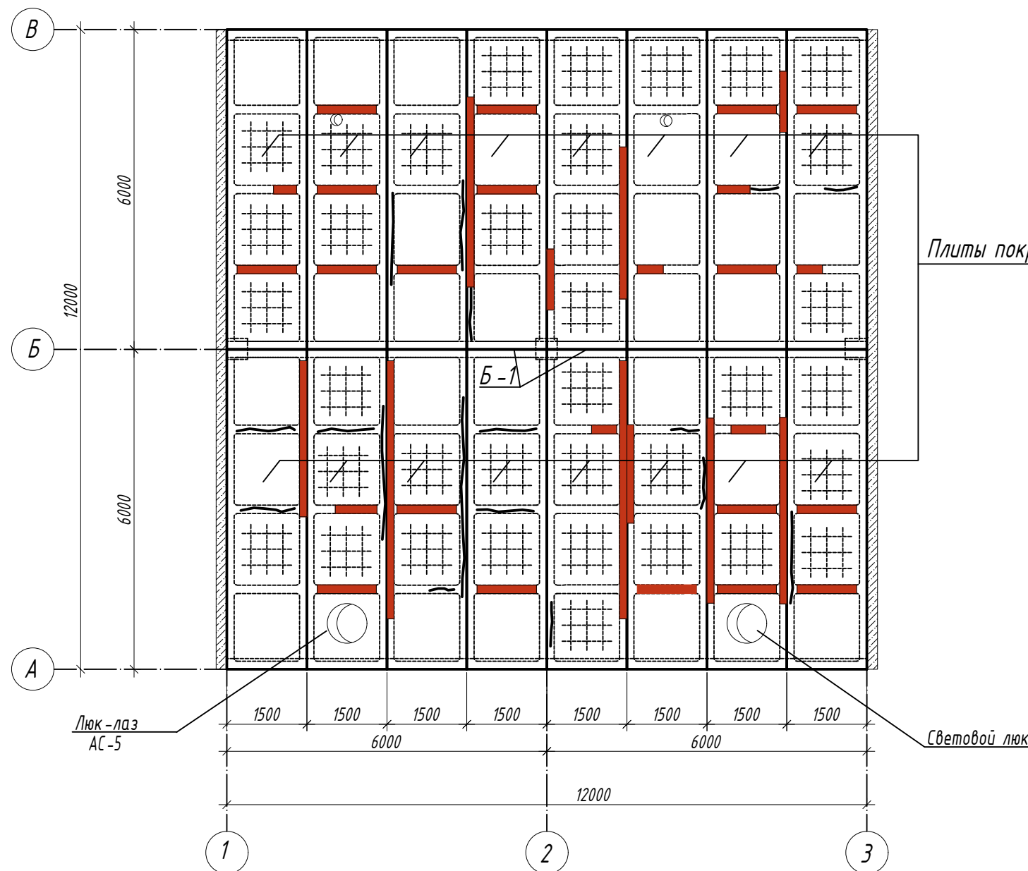
Схема расположения усиления плит УП 1.
