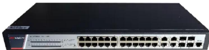
Рисунок 1.6 – DS-3E2528P(B) Гигабитный коммутатор
