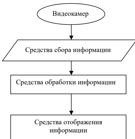
Рисунок 1.1 – Типовая система видеонаблюдения
