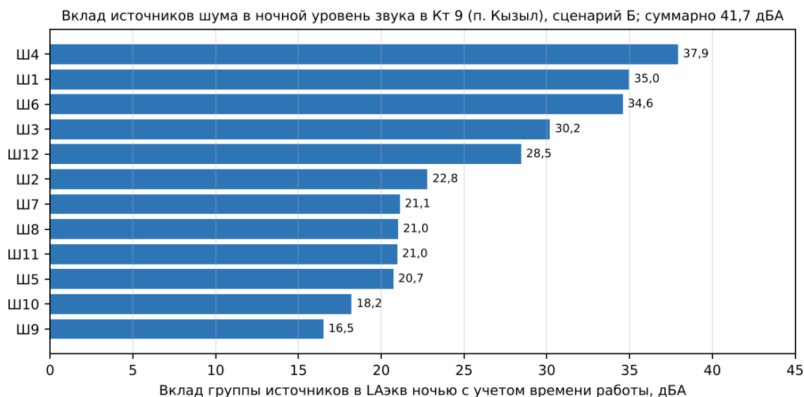
Рисунок 3.4 – Вклад групп источников шума в ночной уровень звука в Кт 9 (п. Кызыл), сценарий Б
